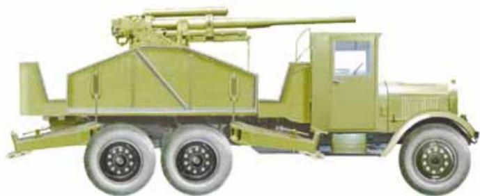
70 мм зенитная самоходная установка 29-К в походном (вверху) и в боевом (справа) положениях
